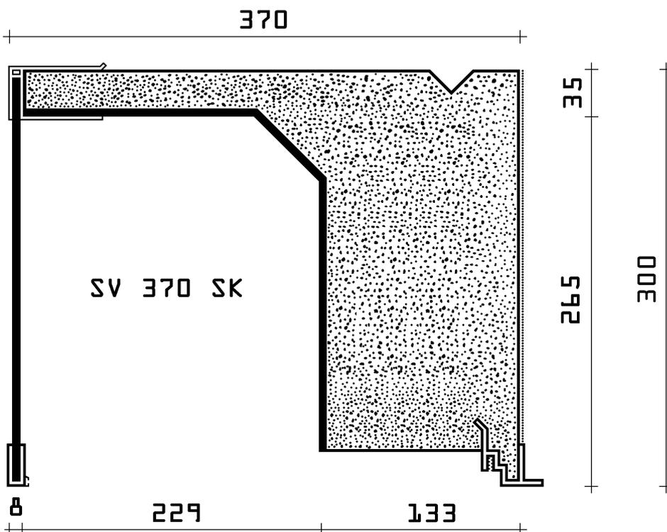
Serienmäßig haben alle Rolladenkästen der Typenreihe SV eine spezielle **Clip - Innenschiene** für den einfachen, schraublosen **EASY - CLIP - Deckelanschluss**, mit 15 mm Ausladung, sowie ein U-Profil als unterem Abschluss an der Außenschürze. (Außenschienen mit einer breiteren Ausladung sind gegen Aufpreis lieferbar.)
